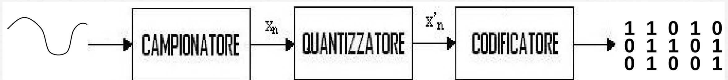
La conversione analogico-digitale trasforma un segnale analogico (valori continui in un tempo continuo) in segnale numerico (valori discreti in tempo discreto).
