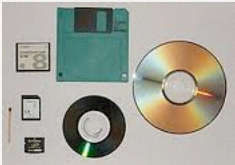
La **tecnologia** normalmente utilizzata per la registrazione è di tipo *magnetico, ottico o elettronico*.
