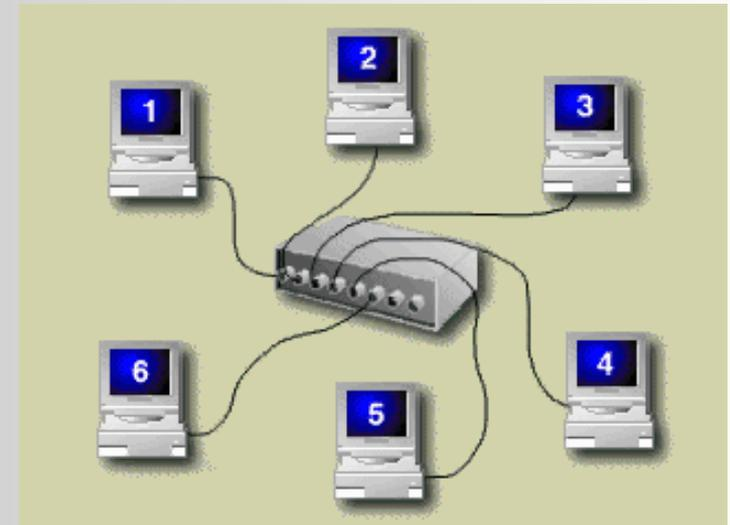
Quando in una rete, di tipo BROADCAST, un dispositivo trasmette dati, tutti gli altri componenti attivi della rete sono in ascolto e solo il destinatario li preleva.
