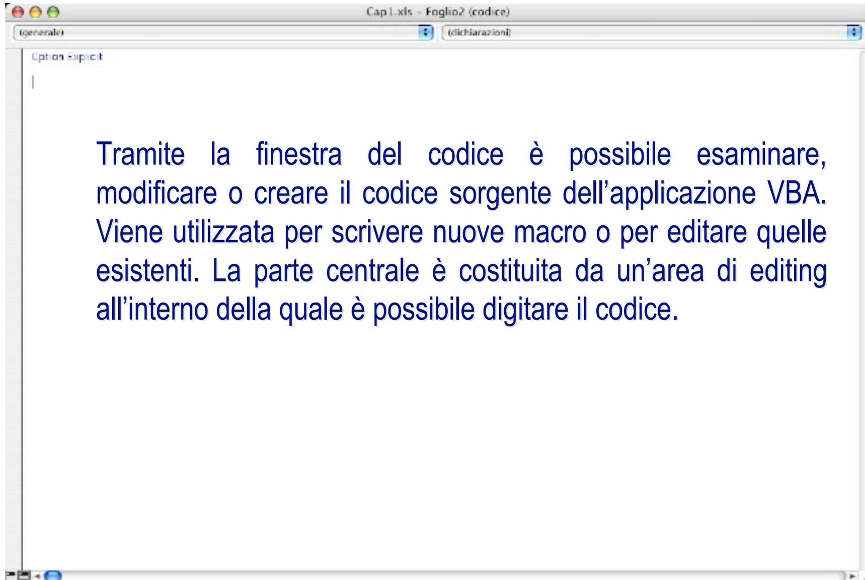
Tramite la finestra del codice è possibile esaminare, modificare o creare il codice sorgente dell'applicazione VBA. Viene utilizzata per scrivere nuove macro o per editare quelle esistenti. La parte centrale è costituita da un'area di editing all'interno della quale è possibile digitare il codice.
