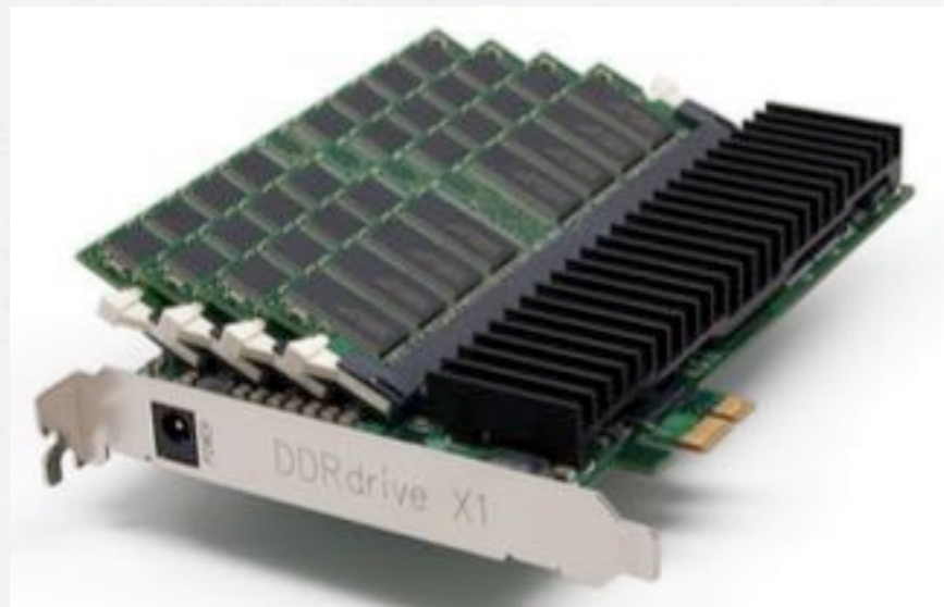
Un SSD PCI-Express-, DRAM- e NAND-based, che utilizza un'alimentazione esterna per rendere la DRAM non volatile.
